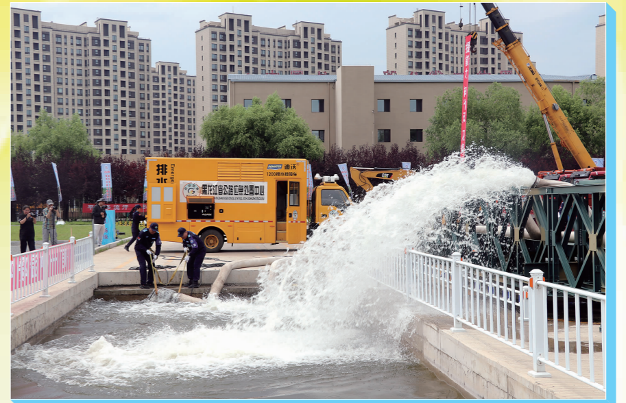
▲应急水泵车排水作业
